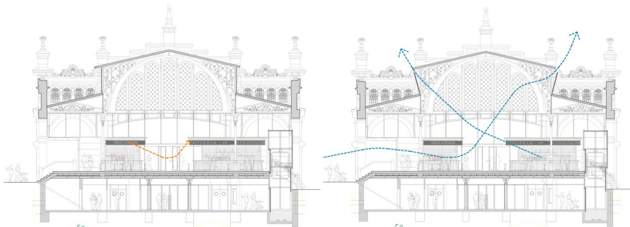
Posibilidad de cierre y apertura temporal o parcial de los claristorios para favorecer la ventilación y mejorar el rendimiento térmico interior.
