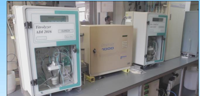
La ETAP dispone de un laboratorio propio para análisis en continuo de los principales parámetros que incluye la normativa del agua potable. Control a la entrada en Planta, salida a distribución y en diversas fases del tratamiento.
